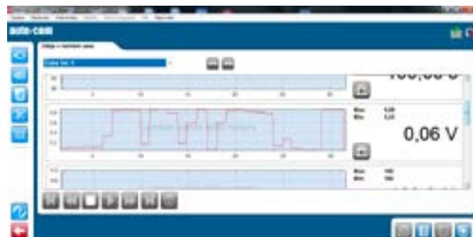
❷ Grafické zobrazení průběhu napětí lambda-sondy.
