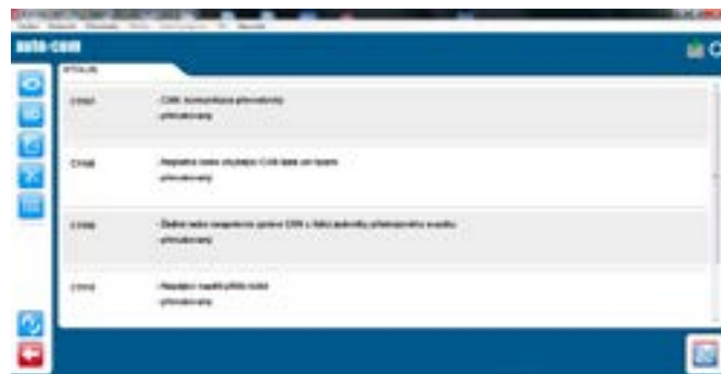
❹ Záznamy o chybách sběrnice CAN v komunikaci s převodovkou.
