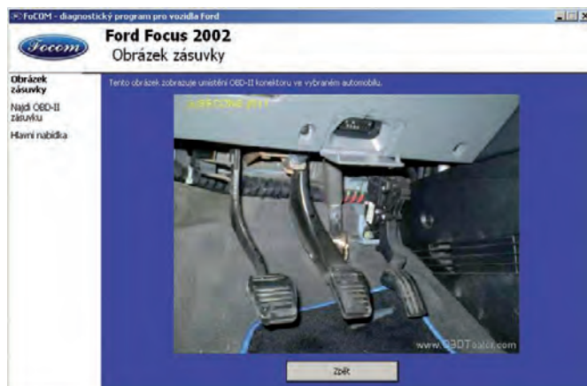
2 Všechny vozy od r. 1996 již mají OBD2 zásuvku. Pouze neznámková diagnostika nabízí možnost zobrazení umístění zásuvky ve vozidle. Na obrázku vidíte zcela standardní umístění.
