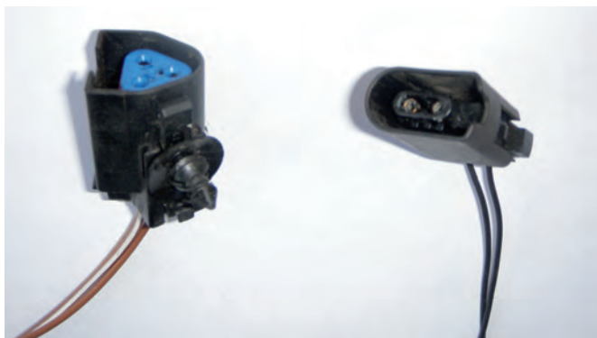
1 „Starý“ diagnostický konektor (dvou- a třípínový).
