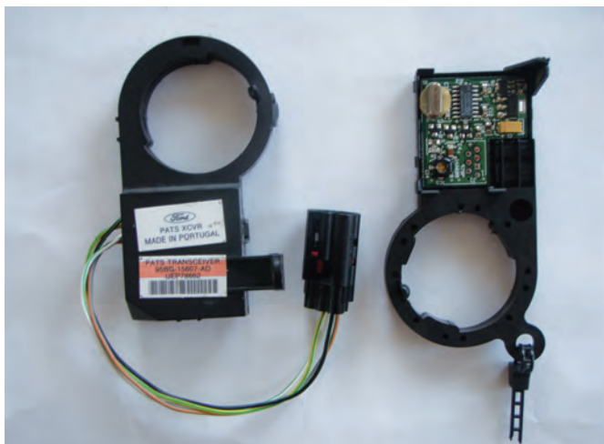
➊ Příklady aktivních antén („čtecích kroužků“) systému PATS, včetně viditelné RF elektroniky.
